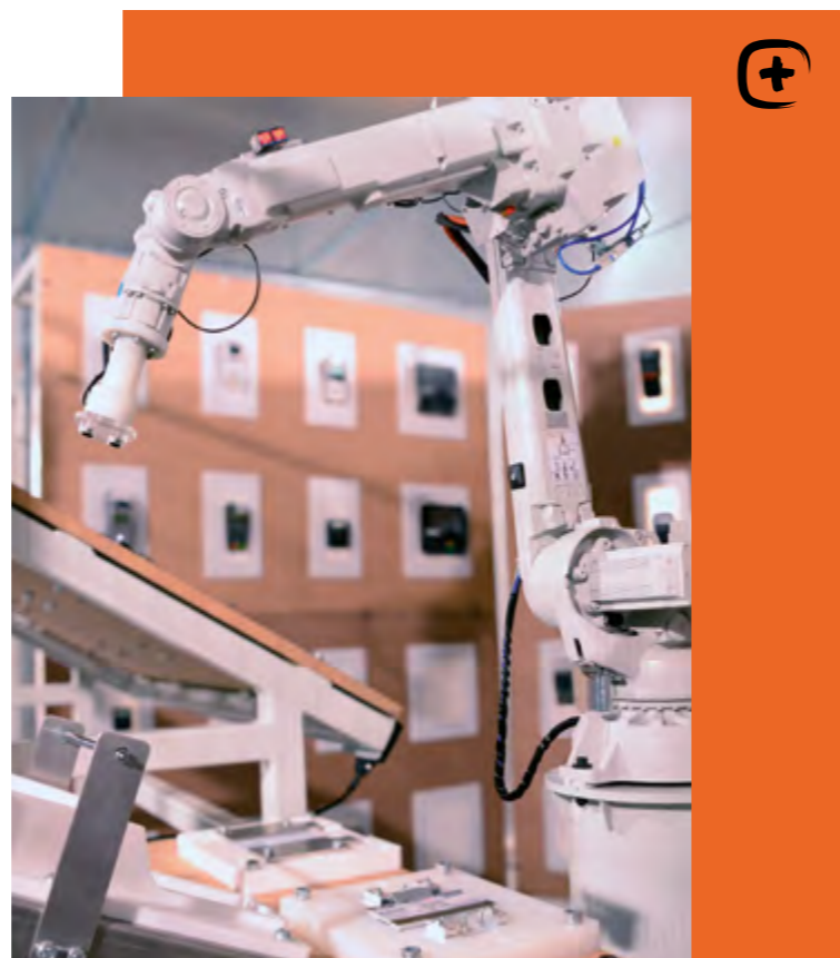
Sistema robotizado: Ensayos de interoperabilidad en terminales de pago, tarjetas y soluciones de pago por móvil.
