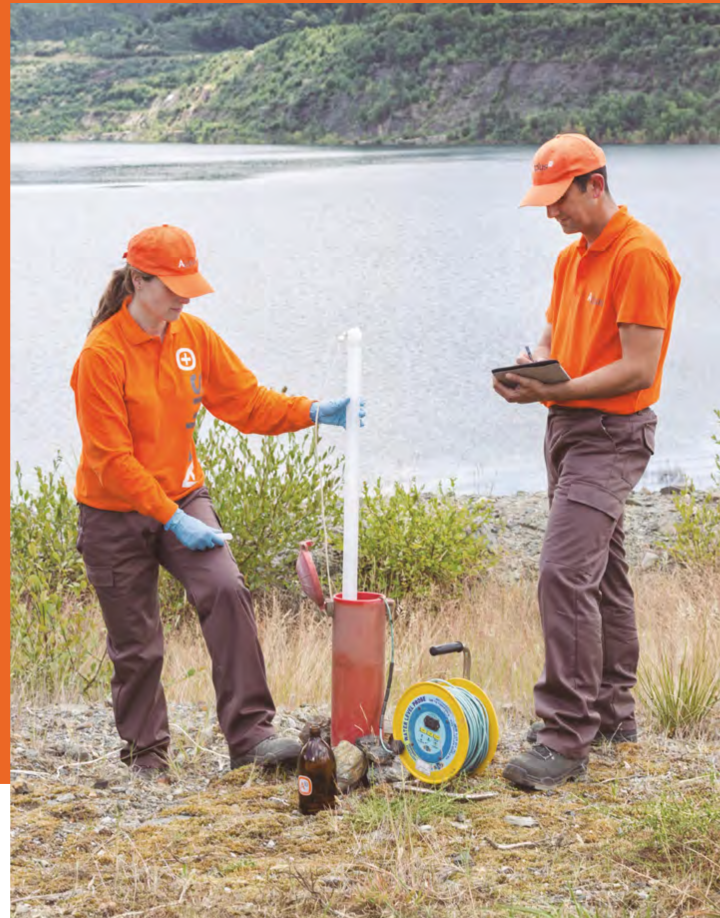
Inspección ambiental, toma de muestras de agua en una mina.
