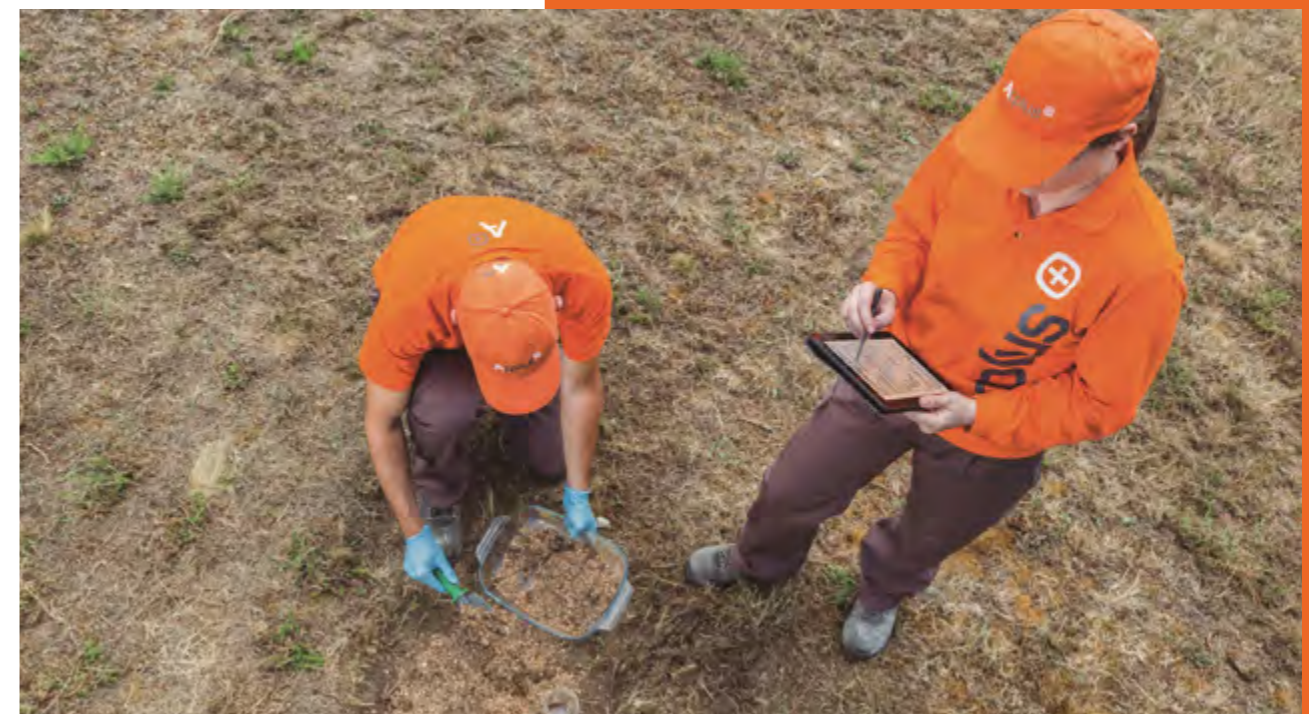
Inspección ambiental, toma de muestras de suelo en una mina.
