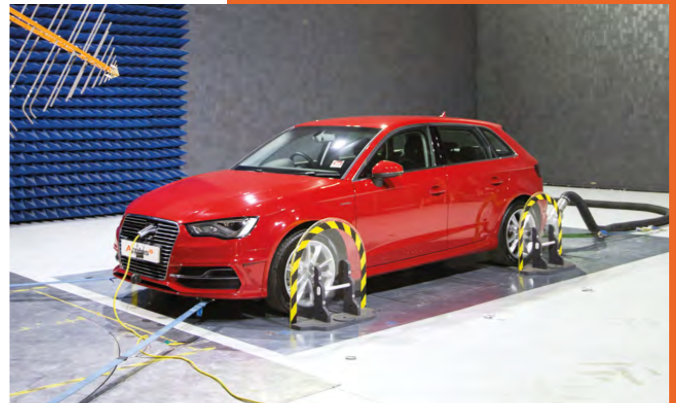
Adquisición de 3C Test. Cámara de ensayos de compatibilidad electromagnética para vehículo completo, en Silverstone, Reino Unido.
