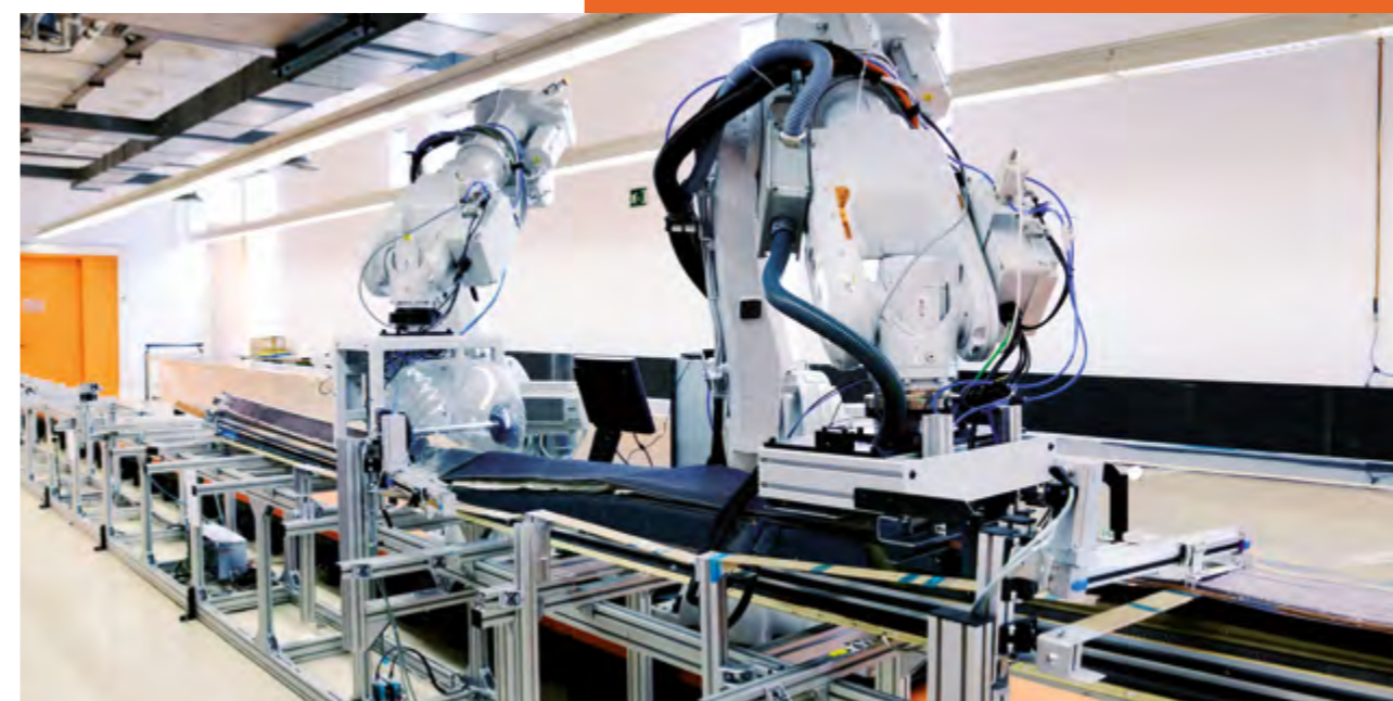
A+ Glide Forming: Tecnología para la fabricación de refuerzos de fibra de carbono.
